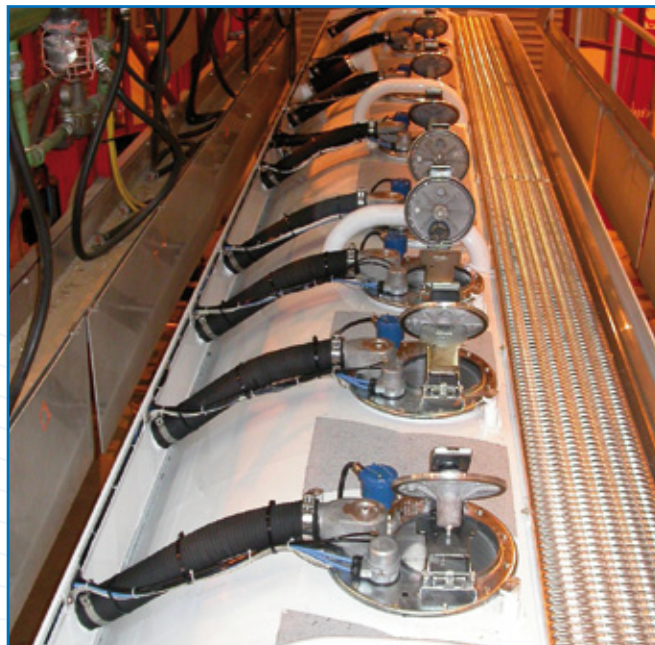
Installation des jaugeurs sur le haut de la citerne
